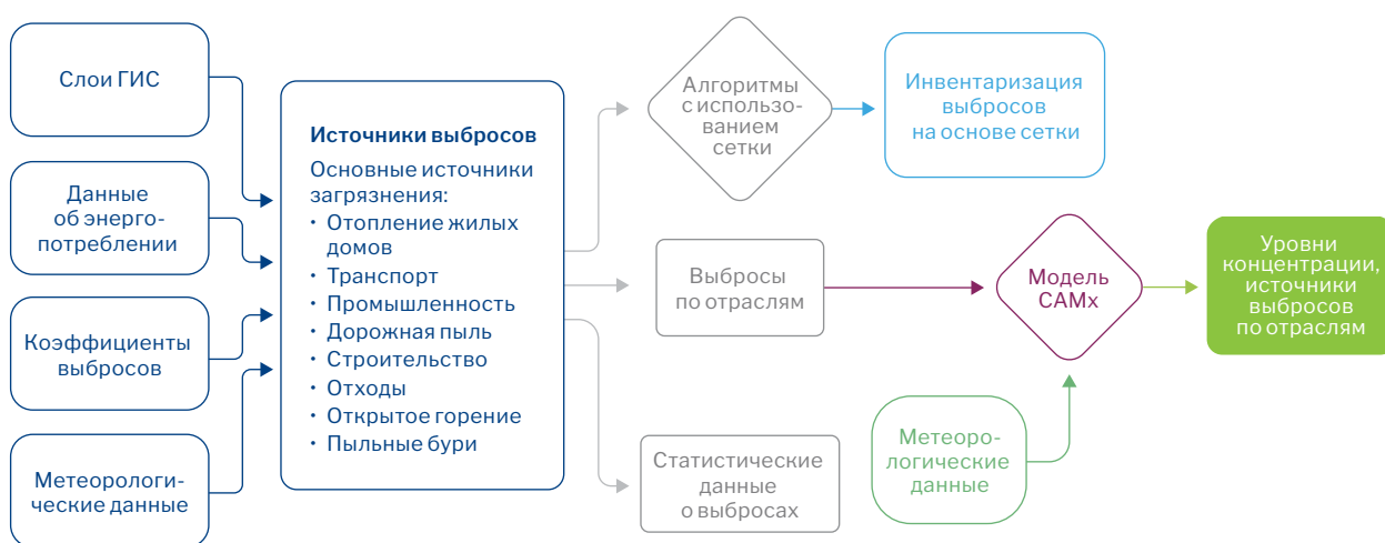
Рисунок А1.11. Структурная схема системы моделирования CAMx
